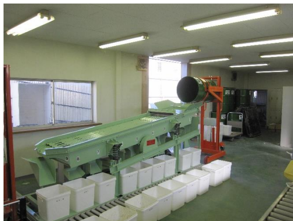
電池選別機 電池の種別に容器が用意されている
