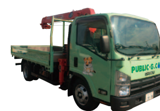
移動式クレーン車 (3t)2台
